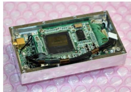
図 3  $\pi/4$  shift QPSK 送信機外観
