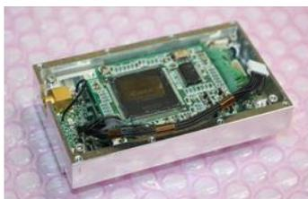
図 2  $\pi/4$  shift QPSK 送信機外観
