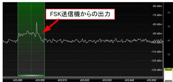
図 9 復調時の電波状態(FSK 送信機)
