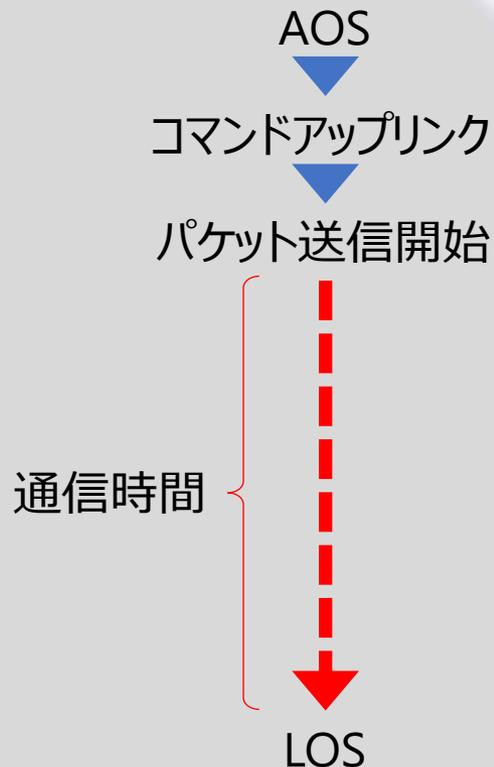
$$\text{実効スループット [bps]} = \frac{\text{1パスに取得したInfo部データ総量}}{\text{通信時間}}$$
