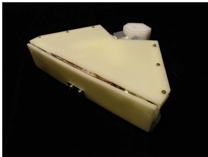
図 3.28 長期収納後展開試験で使用した構造物収納後の収納機構
