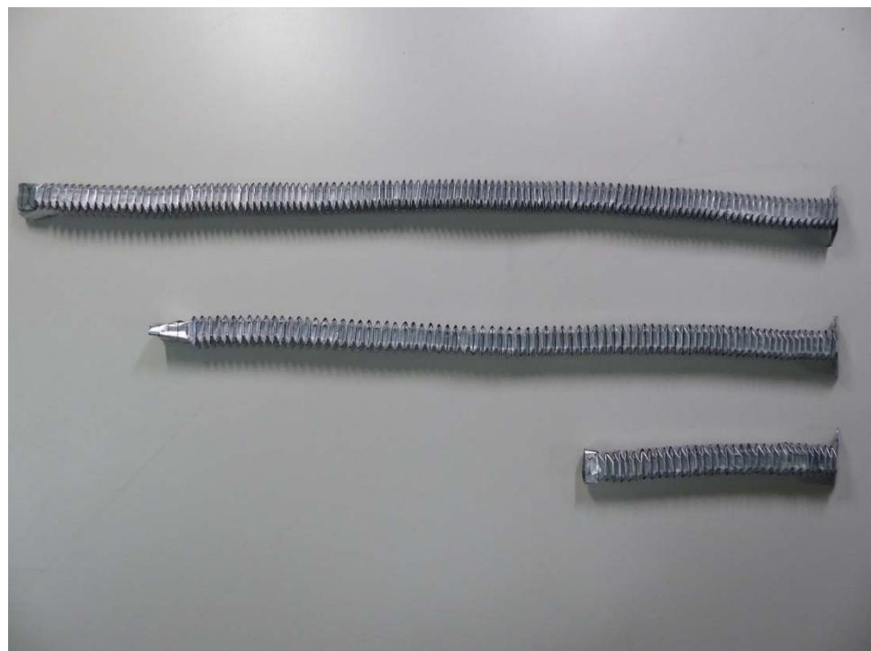
図 3.6 インフレータブルチューブ（上から順に 1562 mm, 1122 mm, 462mm）
