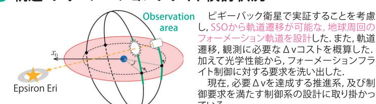
ピギーバック衛星で実証することを考慮し、SSOから軌道遷移が可能な、地球周回のフォーメーション軌道を設計した。また、軌道遷移、観測に必要な $\Delta V$ コストを概算した。加えて光学性能から、フォーメーションフライ制御に対する要求を洗い出した。
