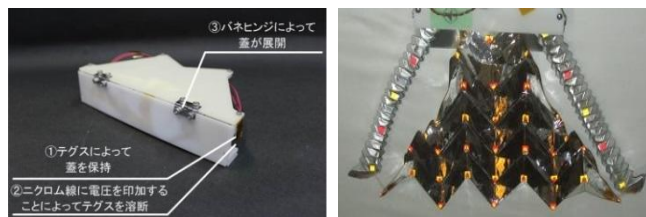
Fig.4 実験供試体(左: 収納状態, 右: 展開状態)
