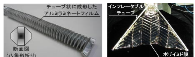
Fig.3 インフレーションチューブ(左)と複合膜面(右)
