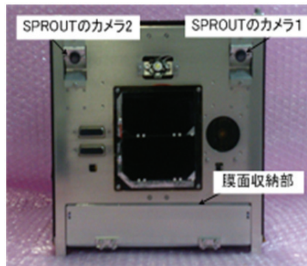
図 6 SPROUT に搭載されている機器の位置関係 また SPROUT に搭載したカメラの諸元を下表 1 に示す．
