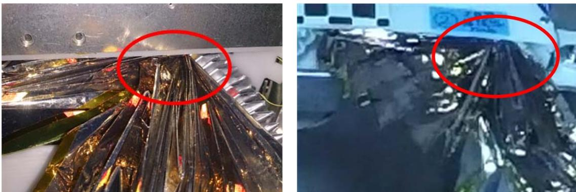
図 4.2 「く」の字型の折り目による膜面の引っかかり (左：地上試験, 右：航空機微小重力実験)
