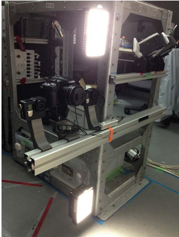
図 10.5 照明・カメラの取り付け位置と角度
