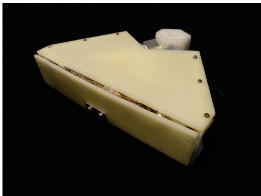
図 3.28 長期収納後展開試験で使した構造物収納後の収納機構
