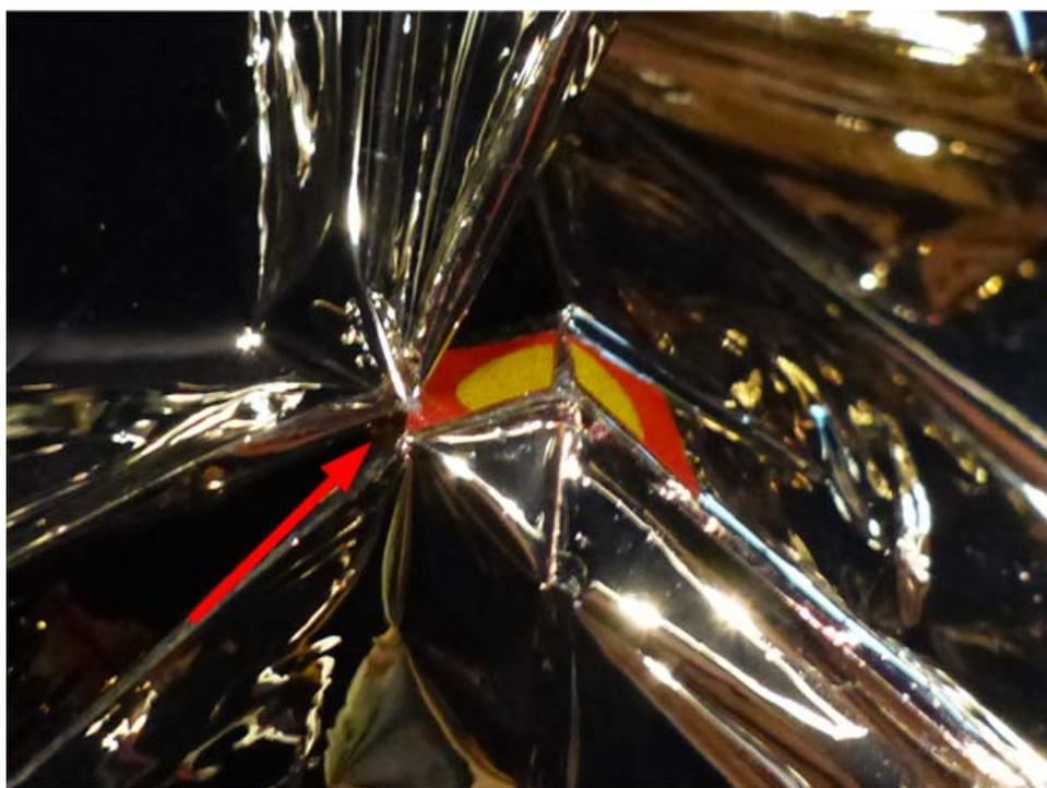
図 4.8 特徴点の粘着層と膜面のくっつき
