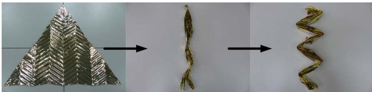
図 5.17 膜面の折り畳み方
