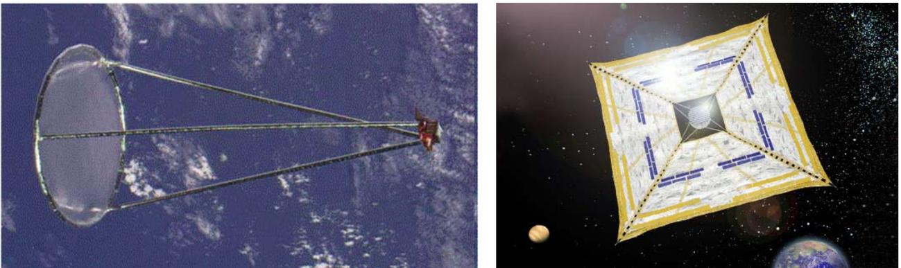
図 1.1 複合膜面構造物の例（左：SPARTAN，右：IKAROS<sup>[4]</sup>）
