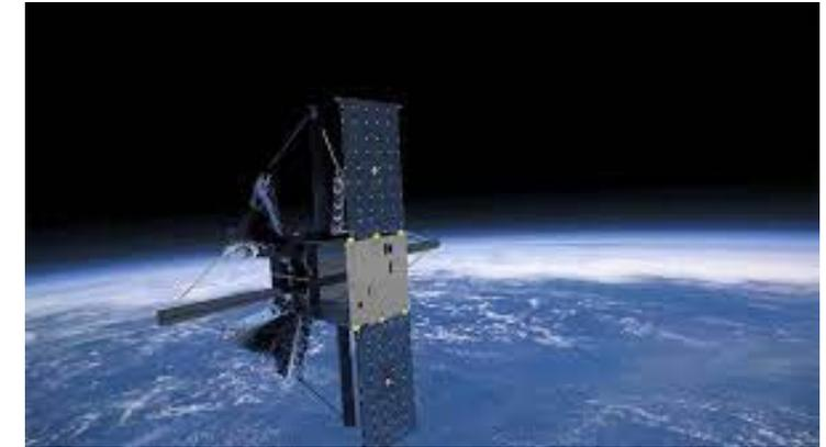
12U(バスが6U, ミッション部が6U). Rocket LabのElectronで打ち上げ予定
